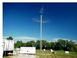
Antenne large bande pour tests électromagnétiques
